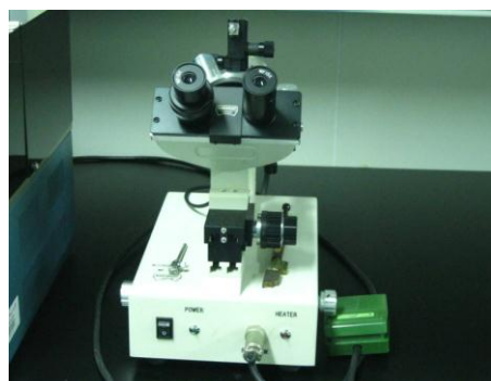
MF -830 microforge 煅针仪，用于显微注射针的修饰
