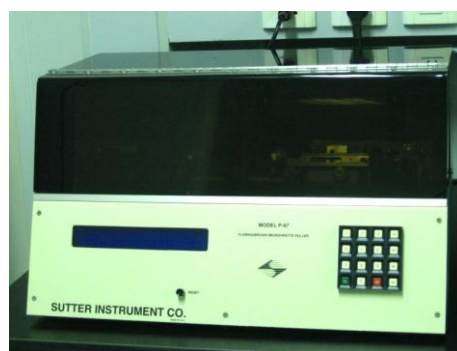
微电极制作仪 model p-97，用于显微注射针的制作
